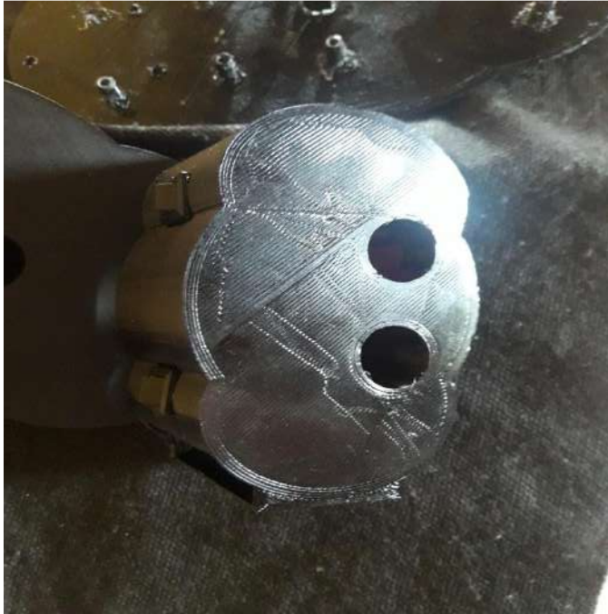
Figura 58: Impresión 3D de la carcasa superior.
