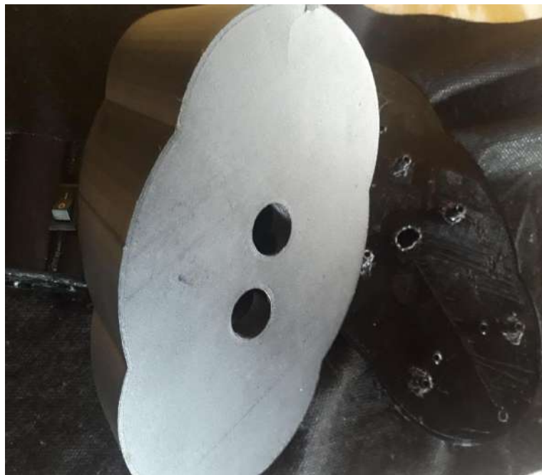
Figura 59: Impresión 3D de la carcasa inferior.
