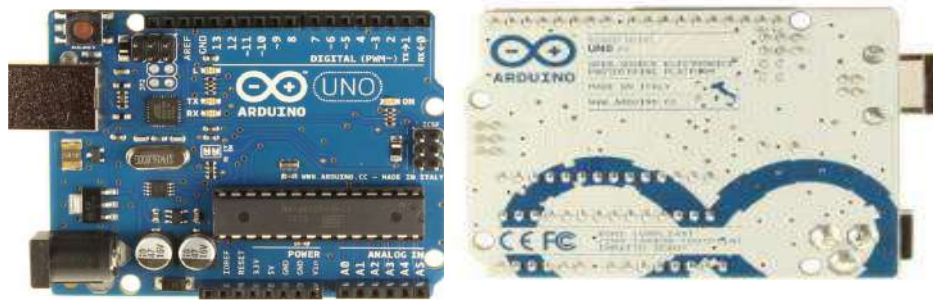
Figura 23: Vista frontal y reverso del Arduino UNO.
