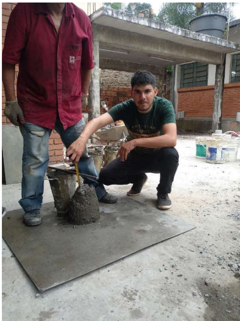
Ilustración 39: Ensayo de asentamiento realizado en el laboratorio de la Fuina
