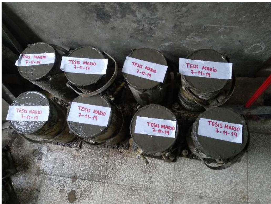
Ilustración 41: Identificación de probetas de hormigón.
