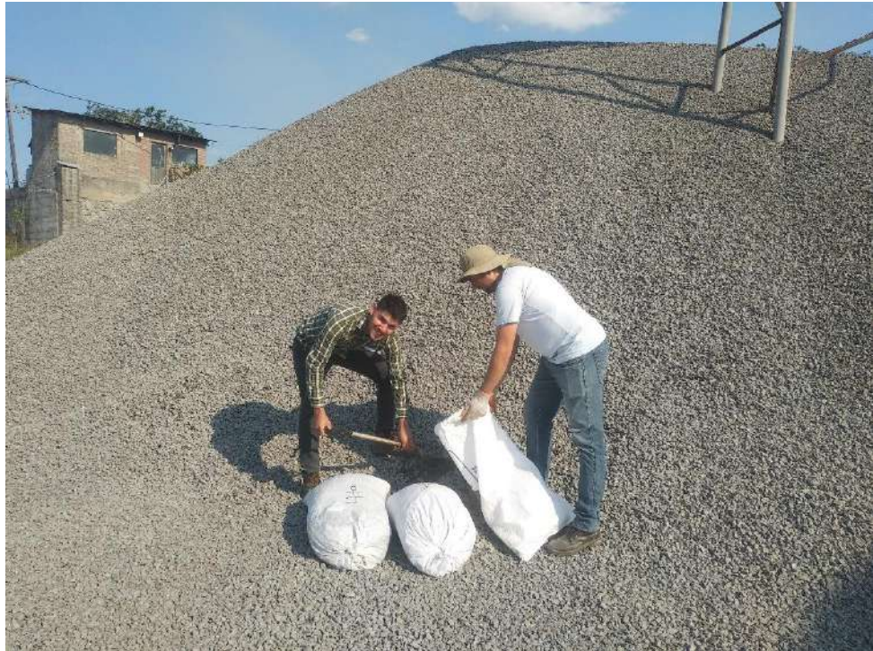
Ilustración 35: Extracción del agregado grueso de la cantera Aguapety para el diseño de la dosificación de solución.
