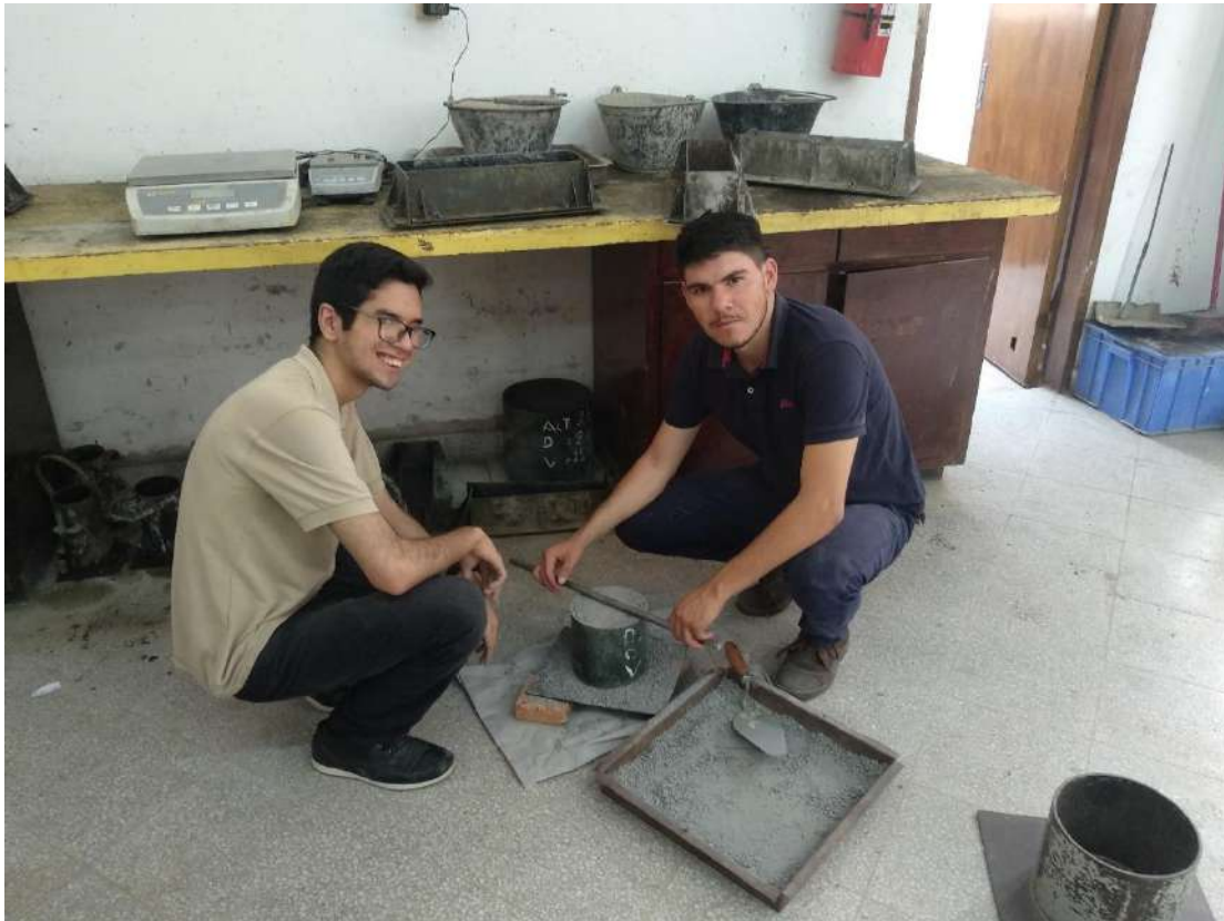
Ilustración 40: Ensayo para determinar el peso unitario suelto.
