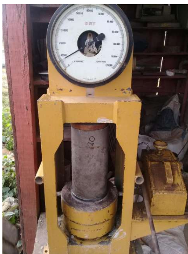
Ilustración 7: Prensa utilizado para ensayo de Resistencia a la Compresión
