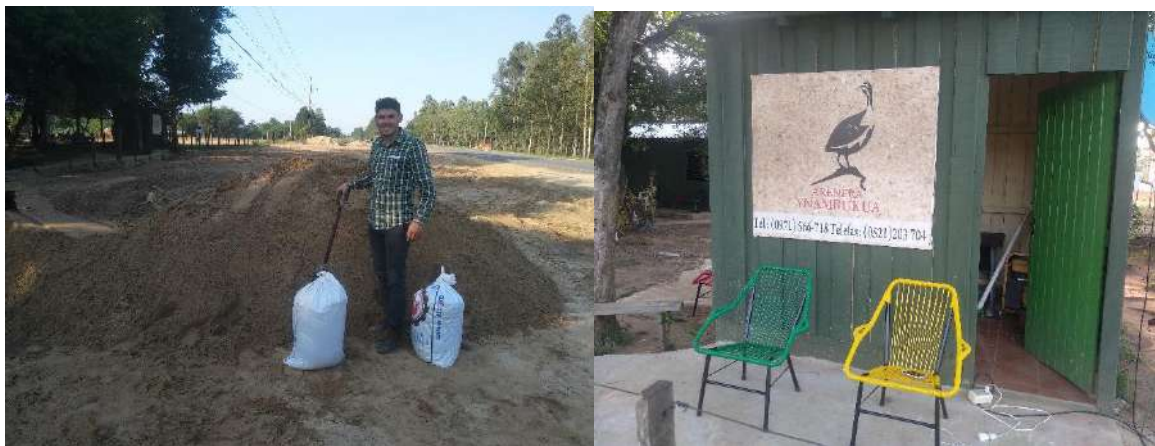
Ilustración 36: Extracción del agregado fino de la Arenera Ynambukua para el diseño de la dosificación de solución
