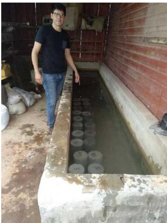
Ilustración 16: Curado de Probetas.
