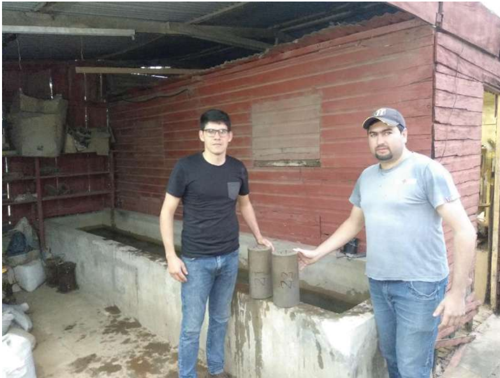
Ilustración 6: Extracción de probetas de la cámara de humedad.
