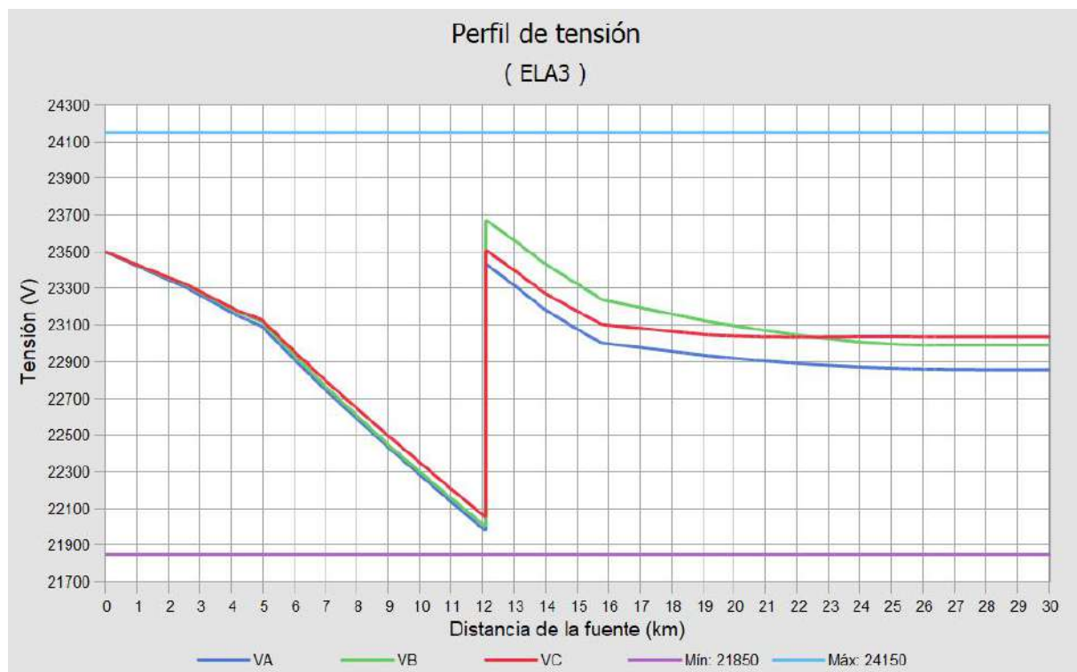
Figura 5.6: Perfil de tensión del ELA-3 posterior al balance de carga
