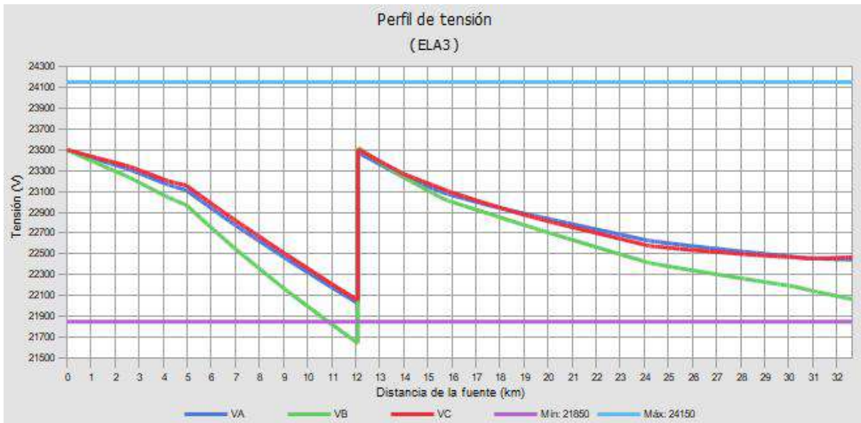
Figura 5.1: Perfil de tensión en escenario base del ELA-3
