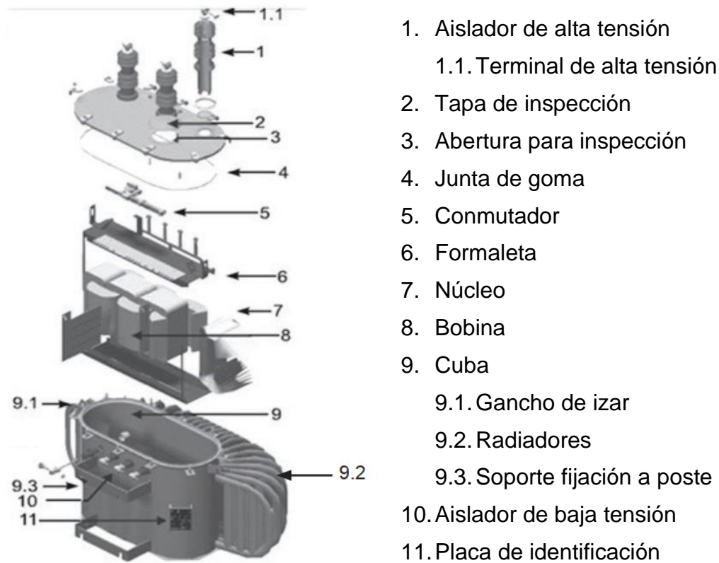
Figura 2.8: Transformador de distribución trifásico convencional
