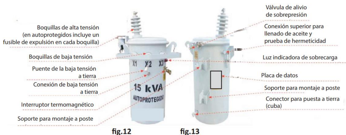
Figura 2.7: Transformador convencional monofásico
