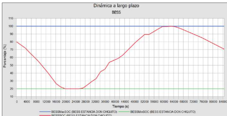
Figura S. 6: Estado de carga del BESS ubicado en la zona Estancia Don Chiquito.
