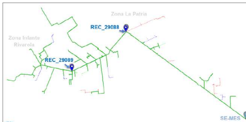
Figura I. 1: Ubicaciones de los reconectores.
