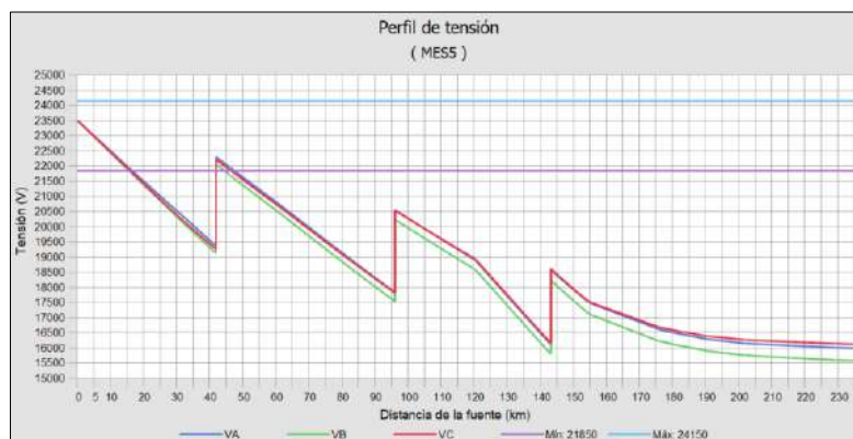
Figura 2: Perfil de tensión del alimentador MES-05 para el año 2029.
