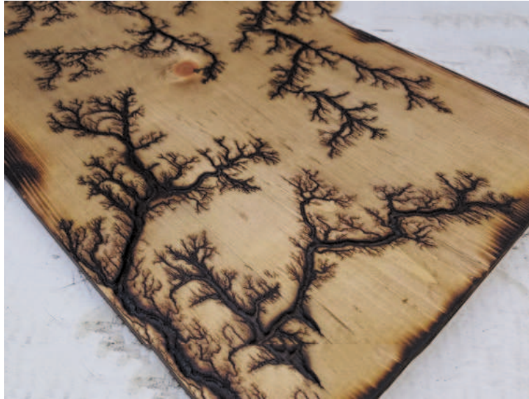
Figura 3.1: Madero sometido a altas tensiones
