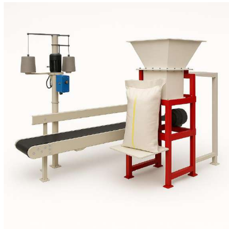
Anexo K. Representación del conjunto mecánico del sistema de embolsado: tolva, soporte de bolsa y cinta transportadora
