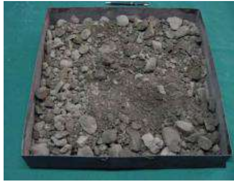
Ilustración 17 Muestra de piedras con varias granulometrías.
