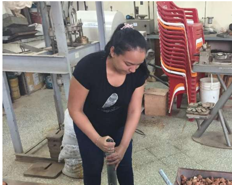
Ilustración 35 Ensayo de Compactación en laboratorio FIUNA.
