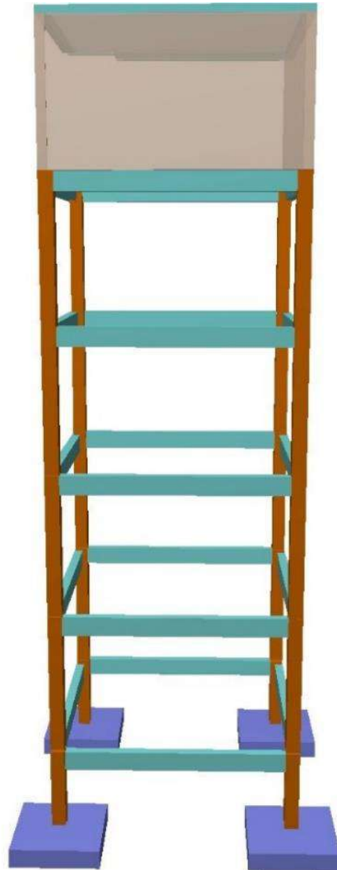
Figura 20. Cálculo Estructural del Tanque Elevado
