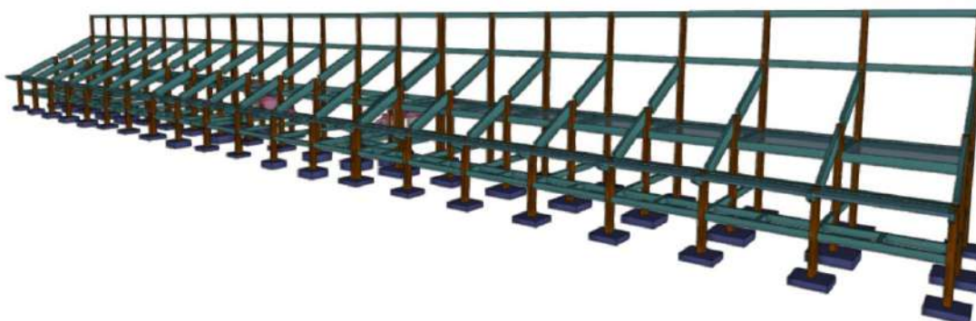
Figura 3. Modelado de la estructura de Hormigón Gradería Este
