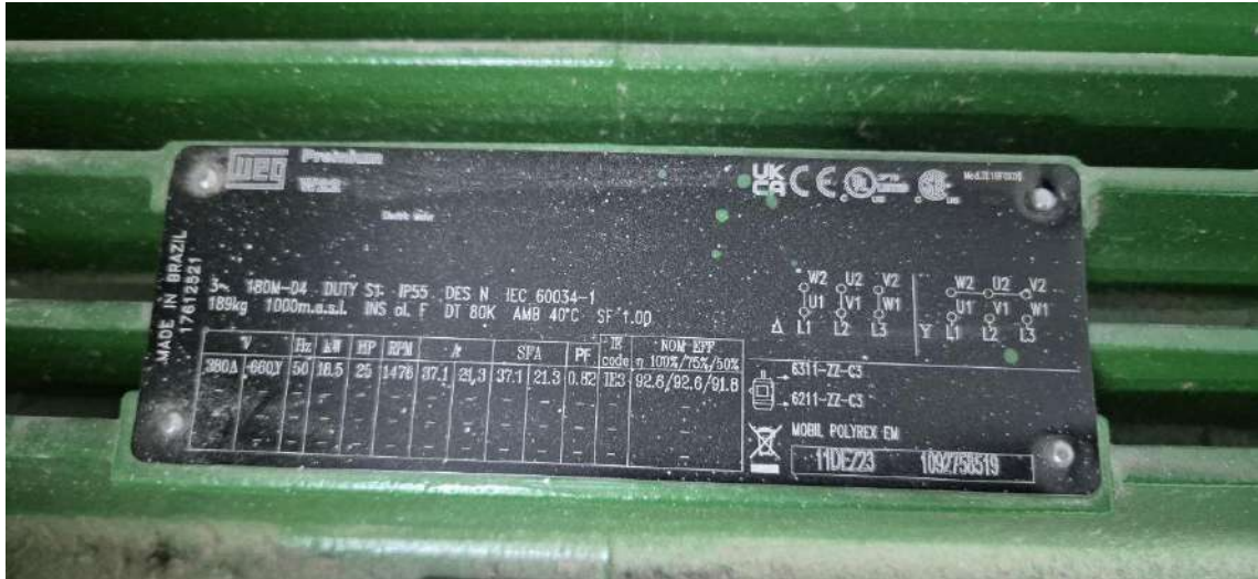
Gráfico 2: Placa del motor WEG W22
