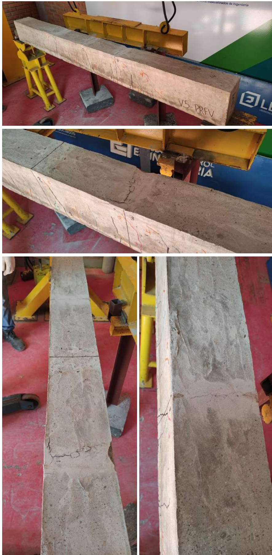
Fotografía 24. Falla por aplastamiento. Viga con refuerzo de PRFV.
