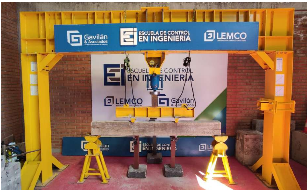
Fotografía 9. Pórtico metálico para ensayo en vigas a flexión.
