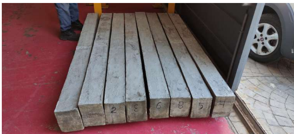
Fotografía 14. Vigas y probetas a ensayar.
