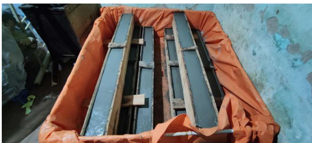
Fotografía 8. Pileta de curado para especímenes de vigas.
