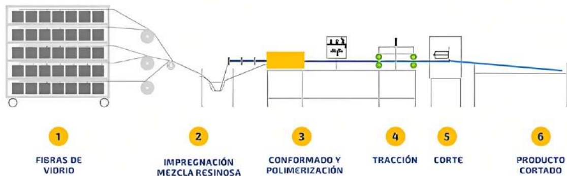
Figura 2. Esquema de proceso de pultrusión de varillas PRFV.
