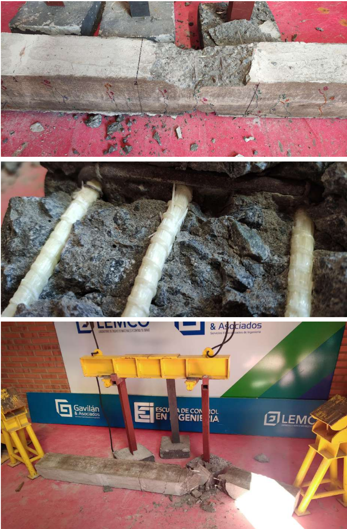
Fotografía 23. Falla por aplastamiento y rotura de PRFV.
