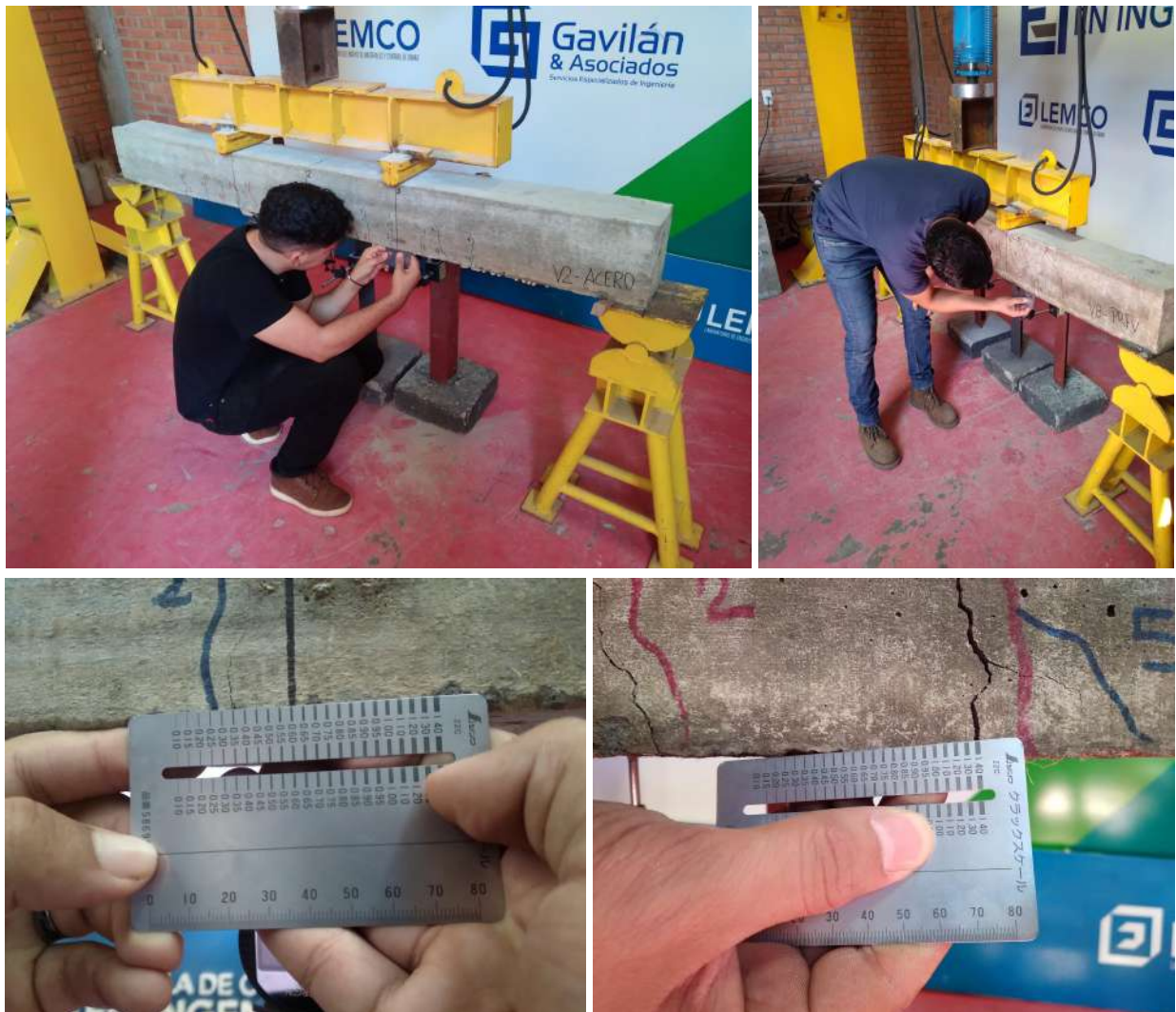
Fotografía 22. Medición y control del comportamiento de fisuras en especímenes de vigas.
