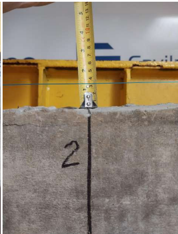
Fotografía 20. Verificación de deflexión en viga armada con acero.
