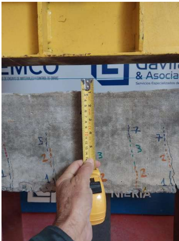
Fotografía 20. Verificación de deflexión en viga armada con acero.
