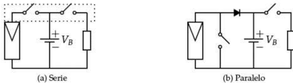
Figura 4.17: Esquema eléctrico de un regulador de carga
