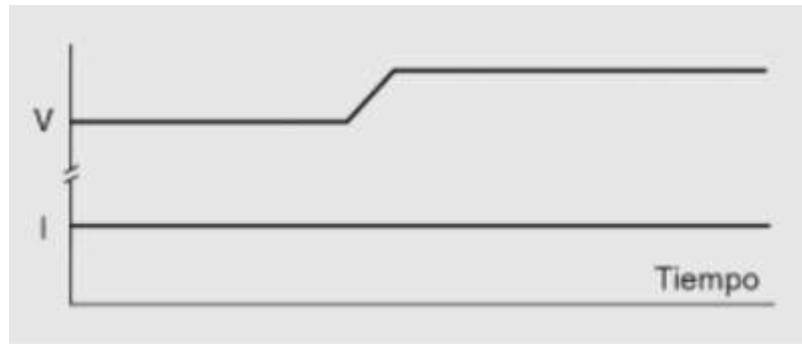
Figura 4.11: Curvas de carga a intensidad constante
