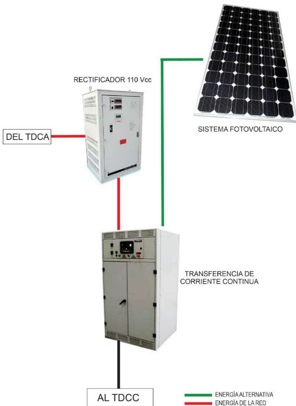
Figura 7.26: Esquema de transferencia en corriente continua
