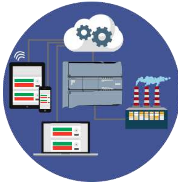
Figura 5. 12:Controlador PLC S7 Visualizado por Web
