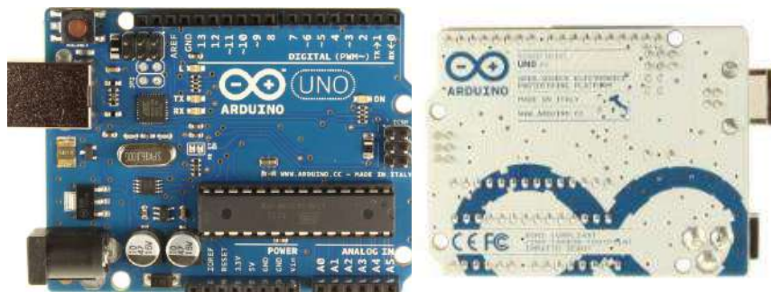
Figura 7.6: Vista frontal y reverso del Arduino UNO R3 [23].
