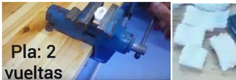
Figura 12.2: Quiebre del plástico PLA en 2 vueltas.
