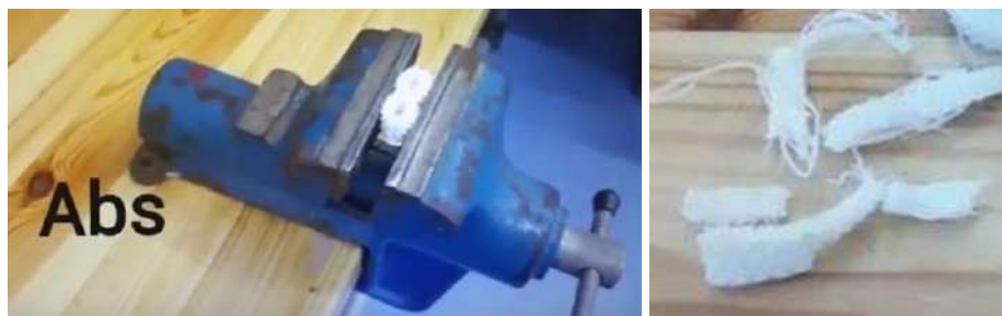
Figura 12.4: Quiebra del plástico ABS a más de 4 vueltas.
