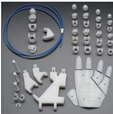
Figura 12.16: Partes de la Mano a ensamblar.
