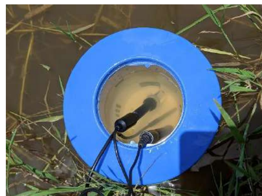
Figura 5.15 Boya flotante instalada en el estanque, con los sensores de medición alojados en el compartimento interno.
