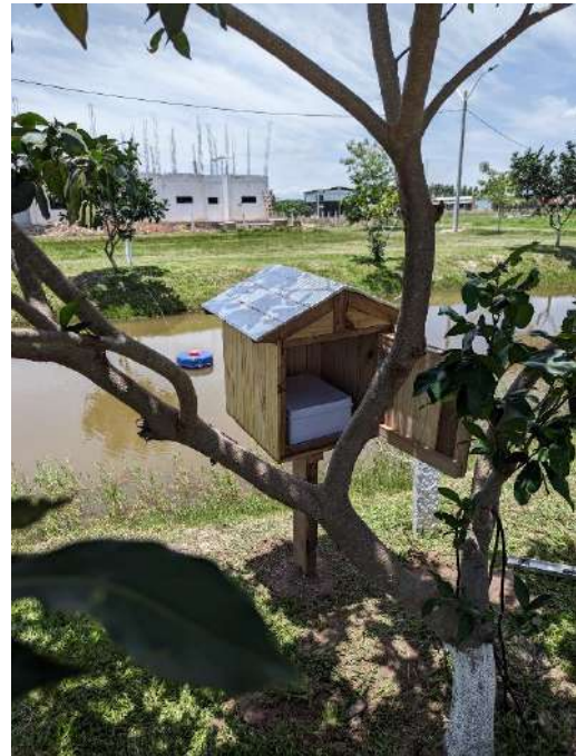
Figura 5.17. Vista de la caseta de madera que protege los equipos electrónicos y la Raspberry Pi
