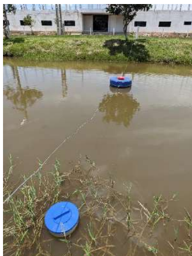
Figura 5.15 Boya flotante instalada en el estanque, con los sensores de medición alojados en el compartimento interno.
