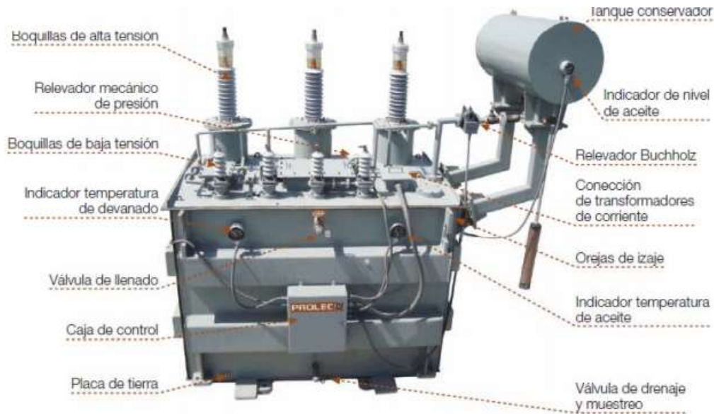
Figura 2 - Transformador de potencia
