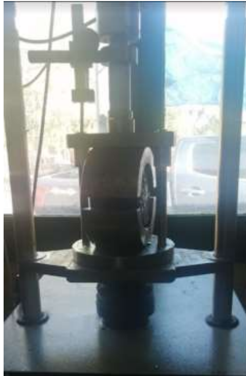
Ilustración 33: Instrumento para determinar la estabilidad y fluencia.
