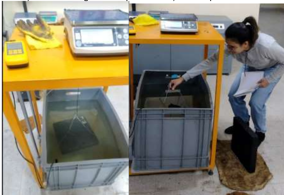
Ilustración 40: a) Masa sumergida de la probeta - b) Secado para obtención de masa SSS.
