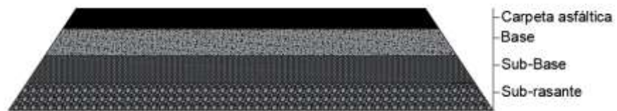
Ilustración 43: Estructura de un pavimento flexible.
