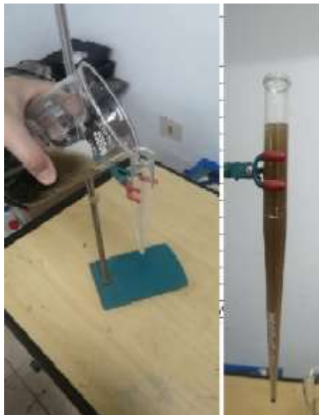
Ilustración 56: Ensayo de polvo adherido.
