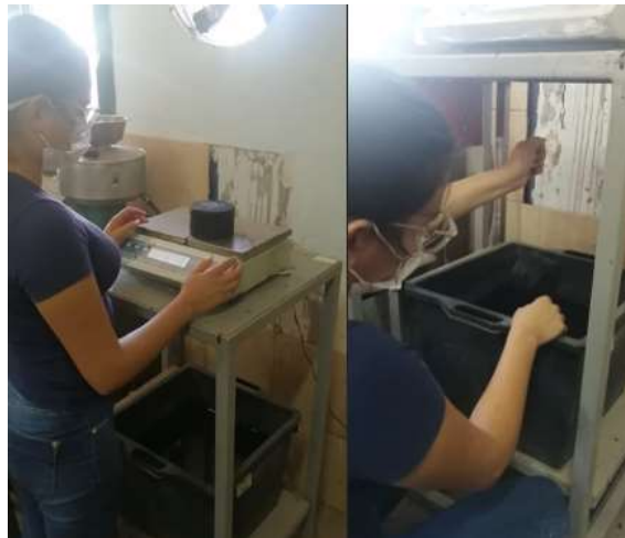
Ilustración 32: a) Peso Seco – b) Peso en agua.
