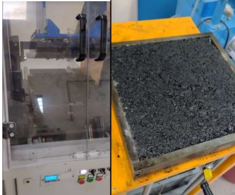
Ilustración 39: a) Mezcla colocada en el compactador. - b) Mezcla compactada.
