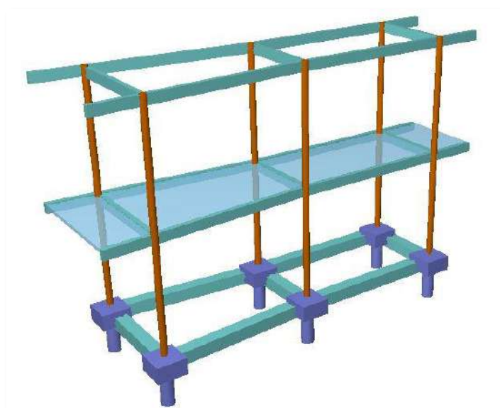
Fig. 5.13 – Modelado 3D de Pasarela entre AULAS B-LABORATORIO
