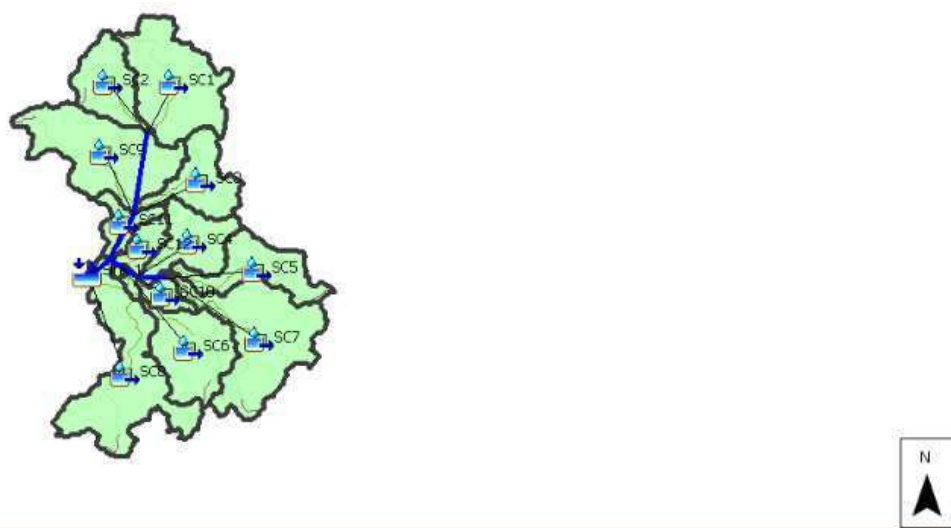
Figura 11 Esquema del modelo conceptual de la cuenca en HEC HMS
