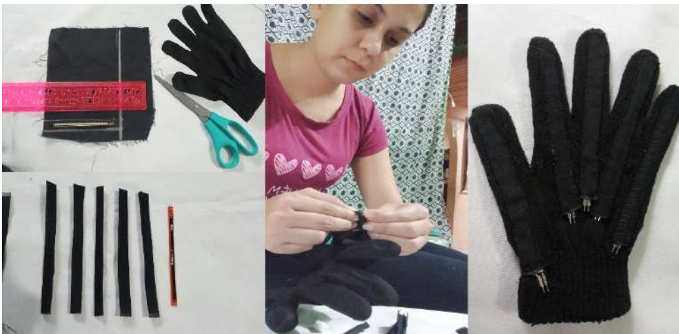
Figura 38. Diseño de tiras para el guante electrónico.
