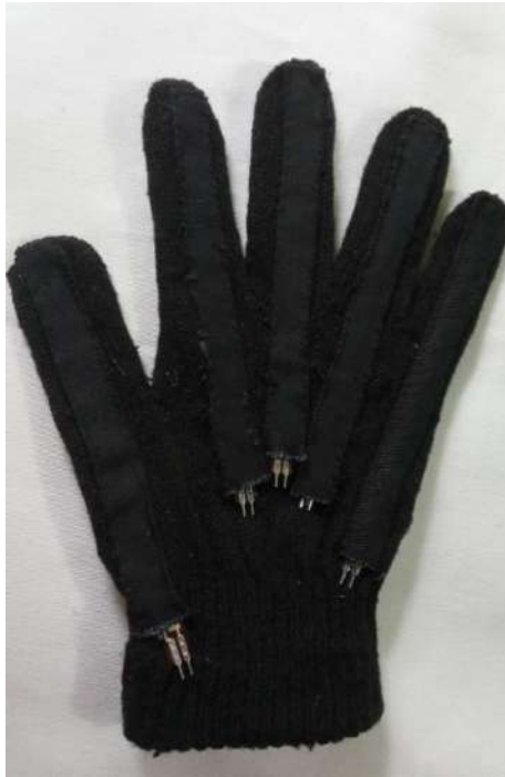
Figura 41. Distribución de sensores en el guante.
