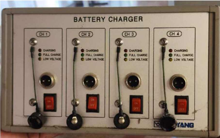
Figura 5. Cargador de baterías para luces.
