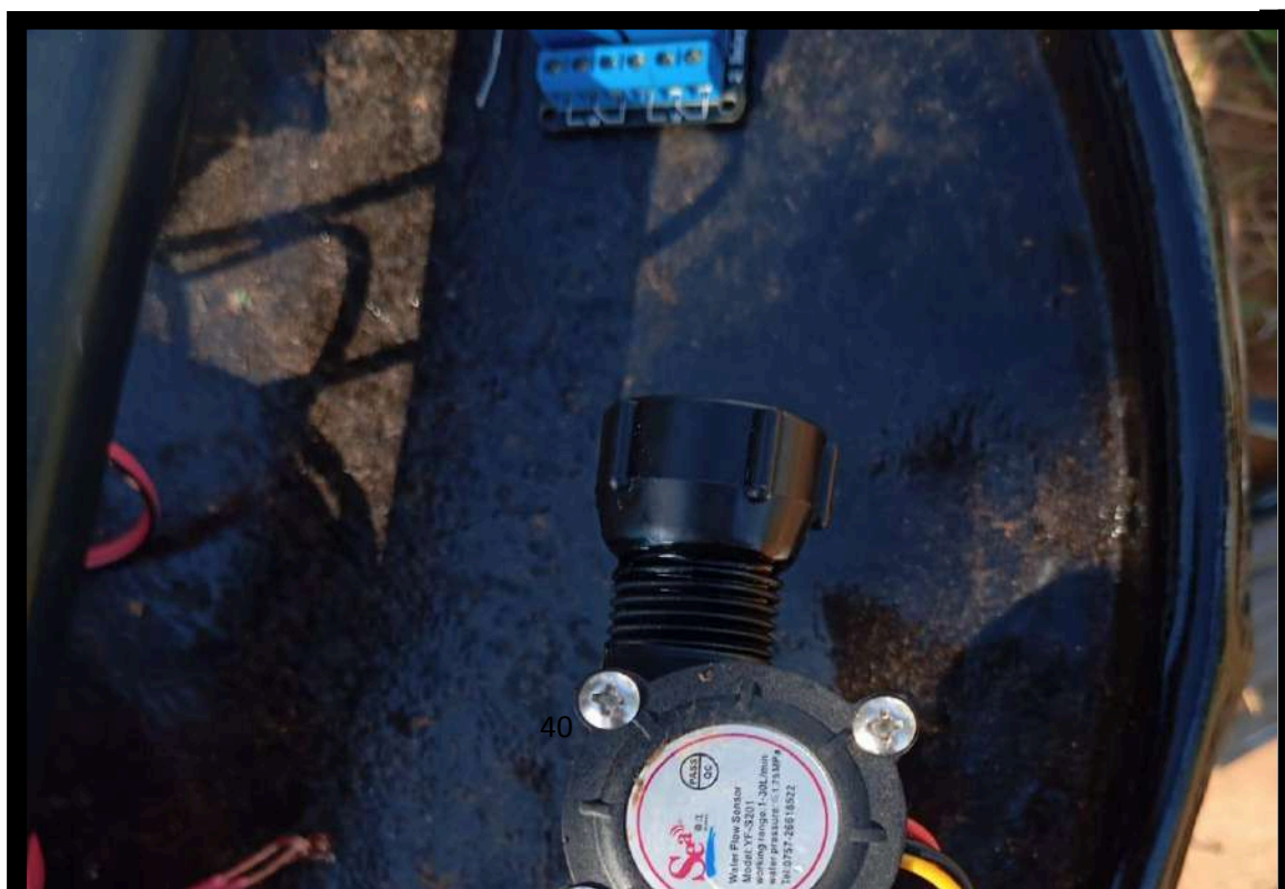
Ilustración SEQ Ilustración \* ARABIC 3 Caudalimetro YF-S201
