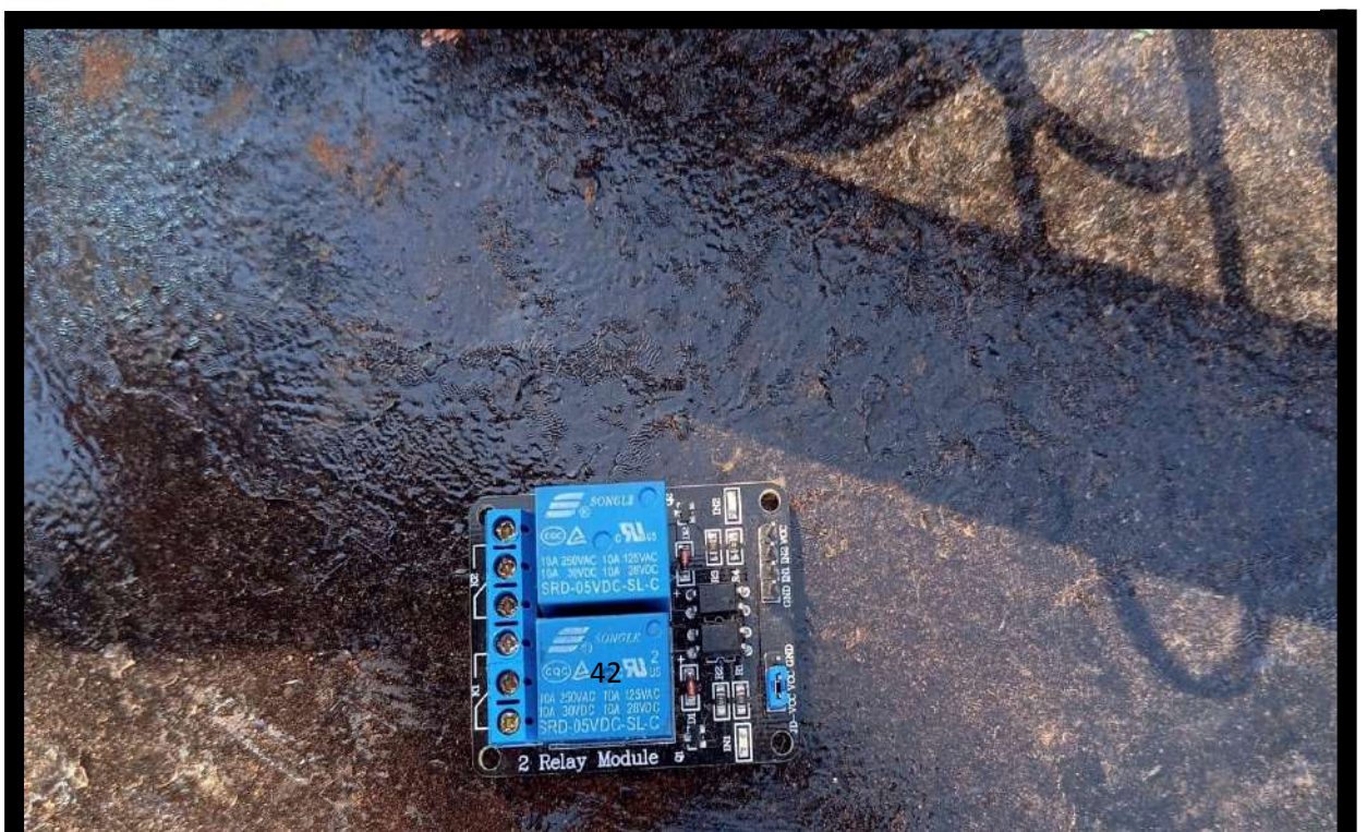
Ilustración SEQ Ilustración \* ARABIC 5 Modulo relé para control de electroválvulas
