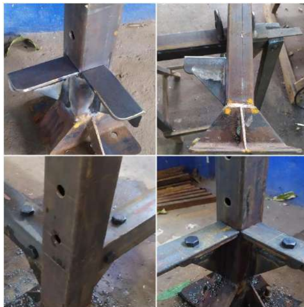
Figura 3. 4 Fabricación de soportes de tensores
