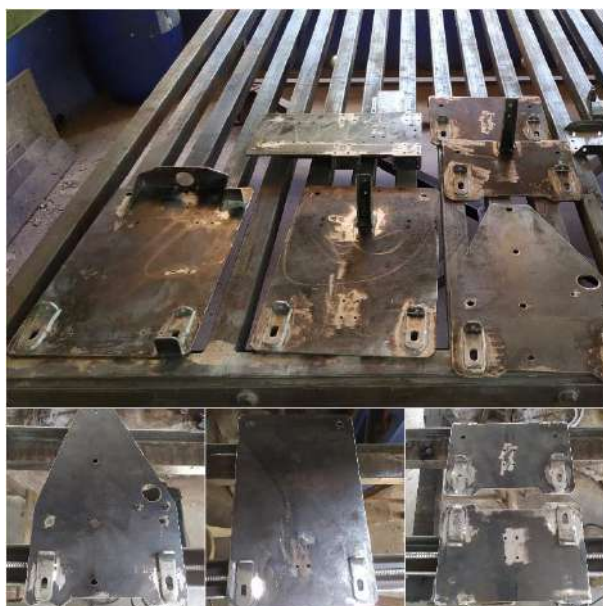
Figura 3. 8 Construcción de las plataformas de los ejes (X, Y, Z)
