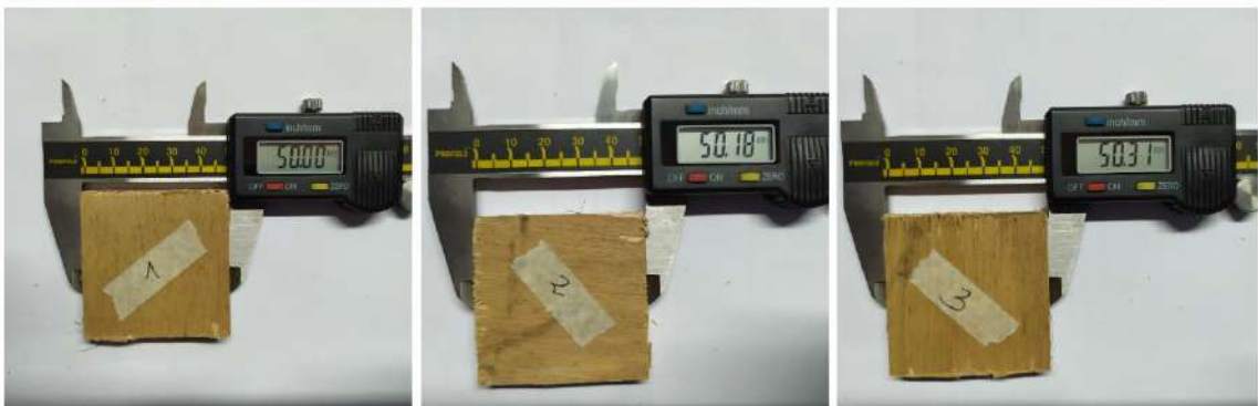
Figura 3. 27 Resultados de la pieza cuadrada de 50 x 50 x 12mm
