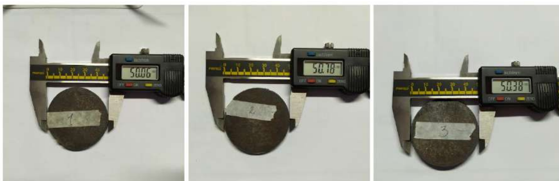
Figura 3. 26 Resultados de la pieza circular de 50mm de diámetro x 4,7625mm
