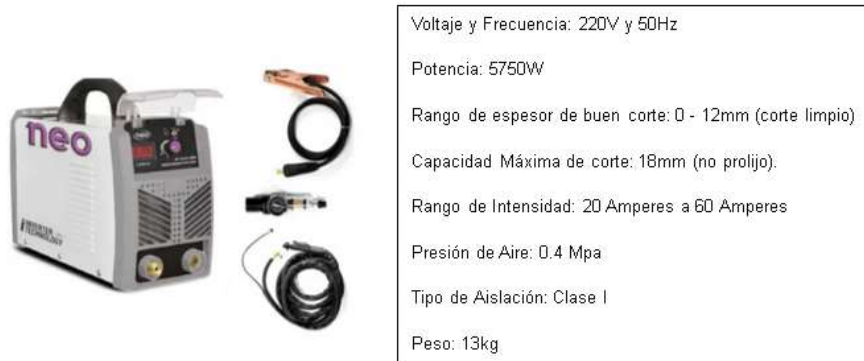
Figura H. 1 Especificaciones técnicas del cortador plasma
