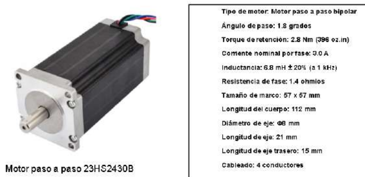
Figura K. 1 Especificaciones técnicas del motor
