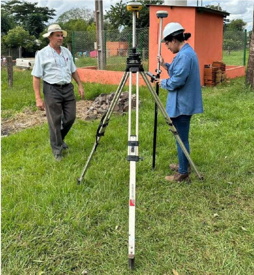
Figura 2: Punto de partida, establecimiento y ajuste del receptor de base
