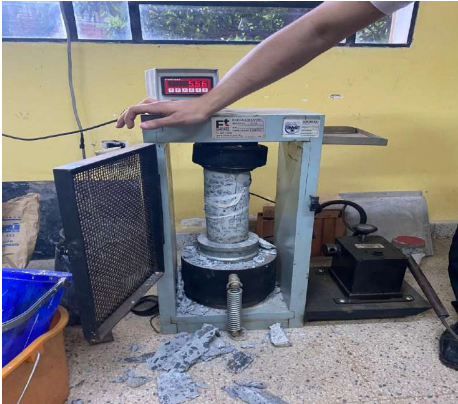
Ilustración D- 6: Rotura de probeta testigo. - Fuente: Elaboración propia.
