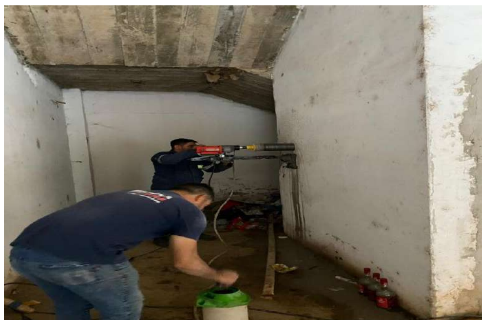
Ilustración 7: Extracción de probetas testigo- Fuente: Elaboración propia
