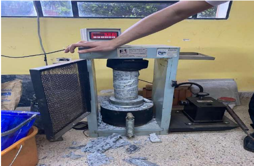
Ilustración 8: Rotura de probetas testigo- Fuente: Elaboración propia.
