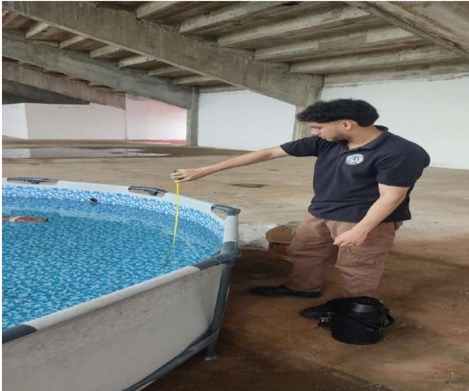
Ilustración C- 2: Realización del ensayo de carga. - Fuente: Elaboración propia
