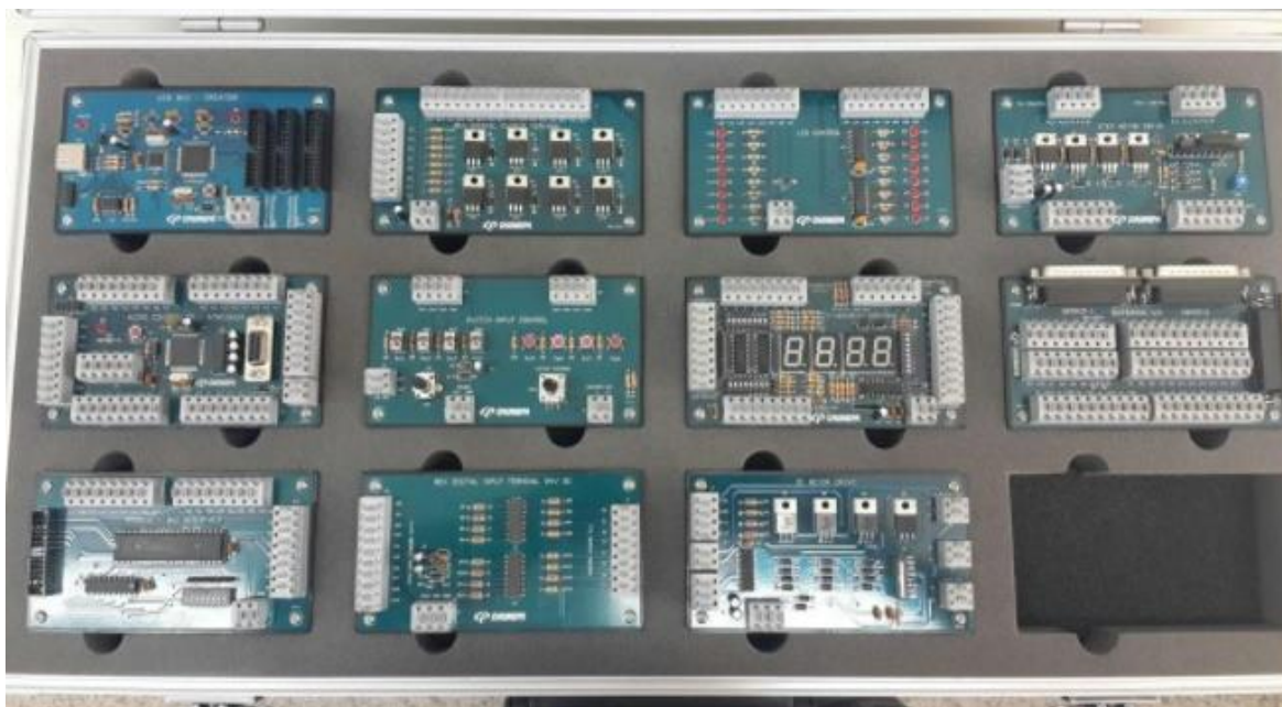
Figura 6.5: Módulos para control por PC
