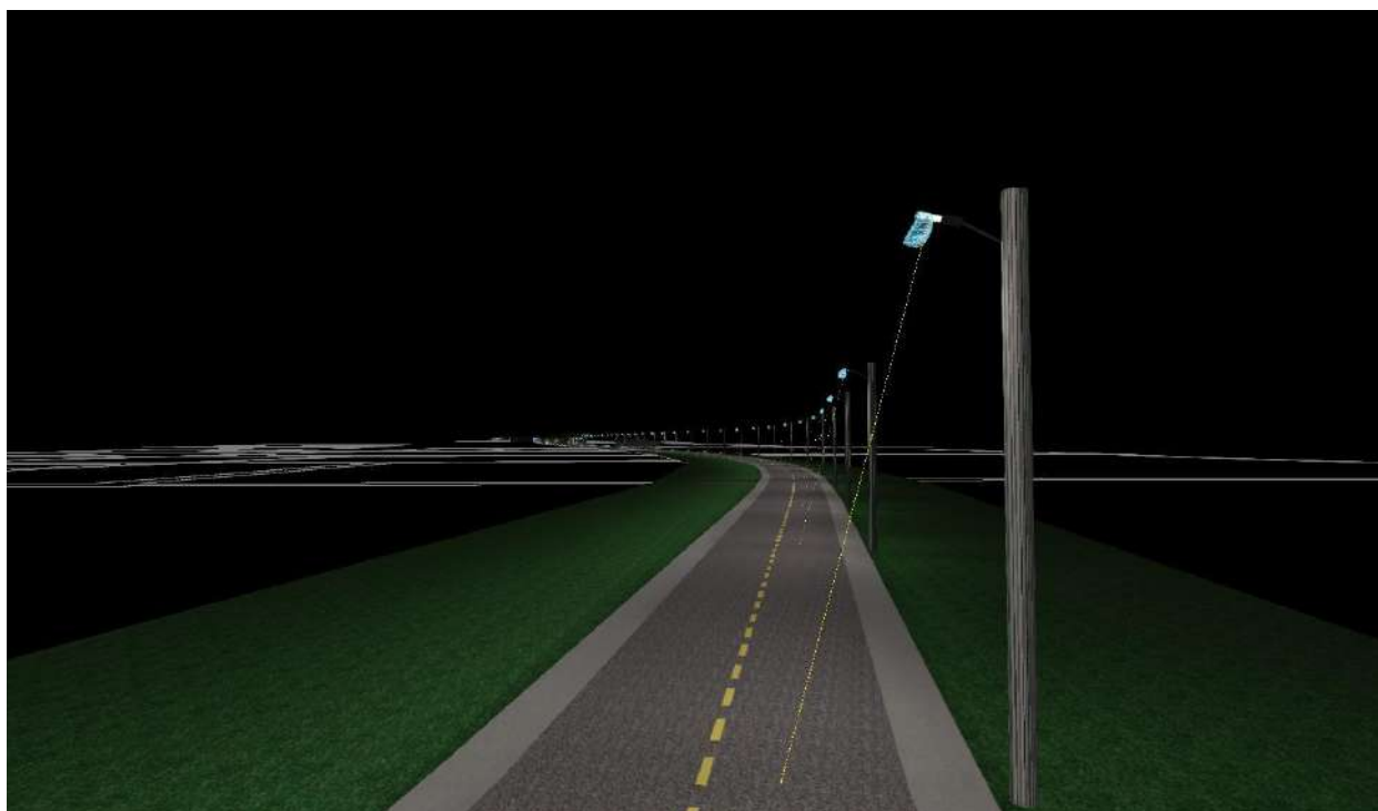
Figura 12. Vista 1 del sistema de iluminación pública para tramo con calzada simple.
