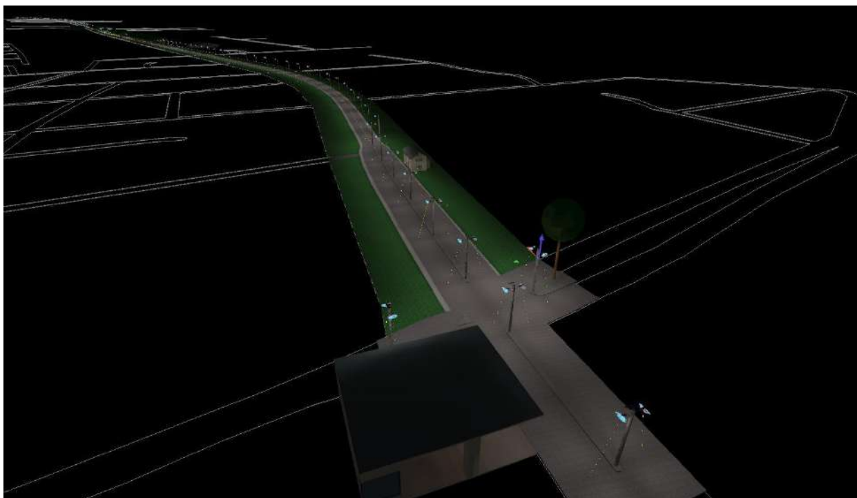
Figura 11. Vista aérea del sistema de iluminación pública para tramo con calzada doble.
