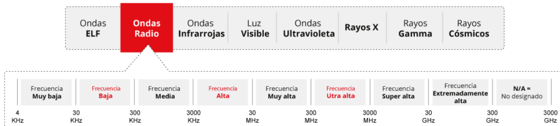
Figura 7.15: Rangos existentes en radio frecuencia (RF)
