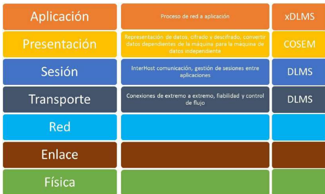
Figura 6.4: Modelo de capas de DLMS/COSEM [69]
