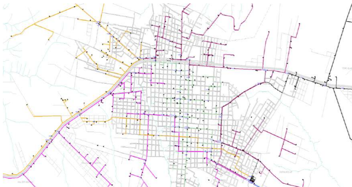
Figura 10.14: Puestos de distribución ubicados en los cascos urbanos – periféricos de Caaguazú. Fuente [ANDE]
