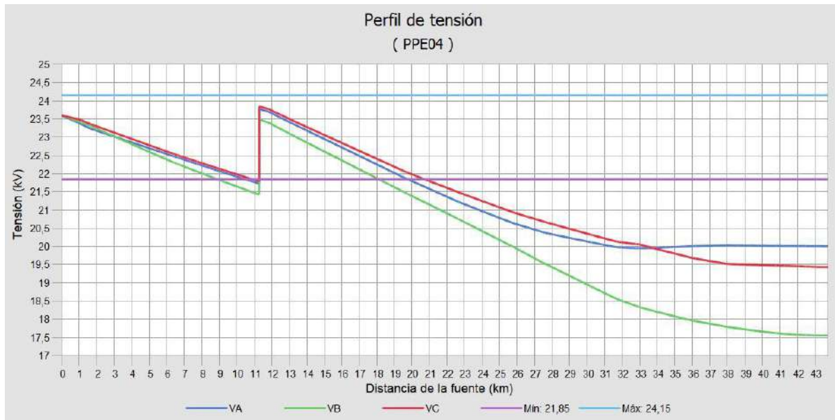
Figura 6: Perfil de tensión a lo largo del alimentador
