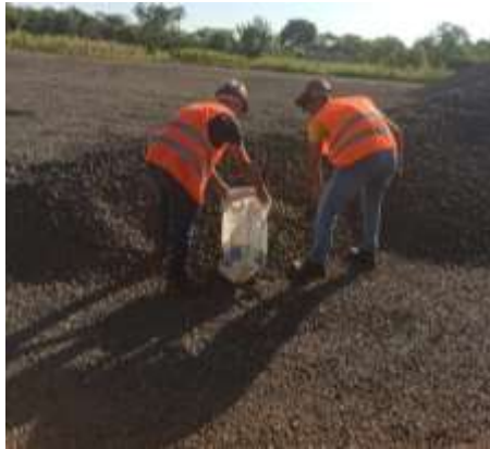
Ilustración 10 – Recolección de agregado grueso en la Cantera 8a de coronel Oviedo.
