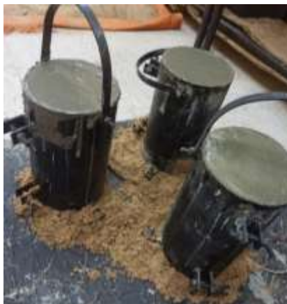
Ilustración 14 - Hormigón fresco en el molde.
