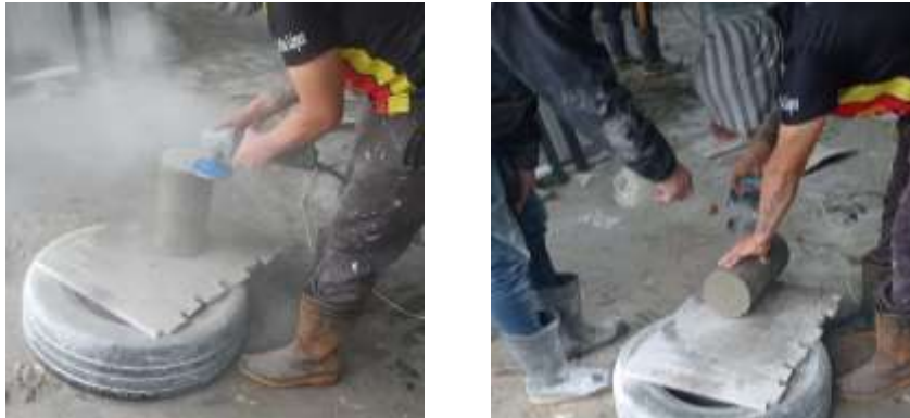
Ilustración 16 - Corte de probetas y proceso de pulido.
