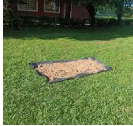
Ilustración 6 - Secado de agregado fino
