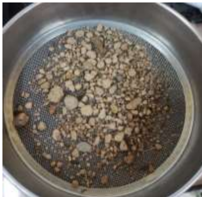
Ilustración 7 - Limpieza del agregado fino
