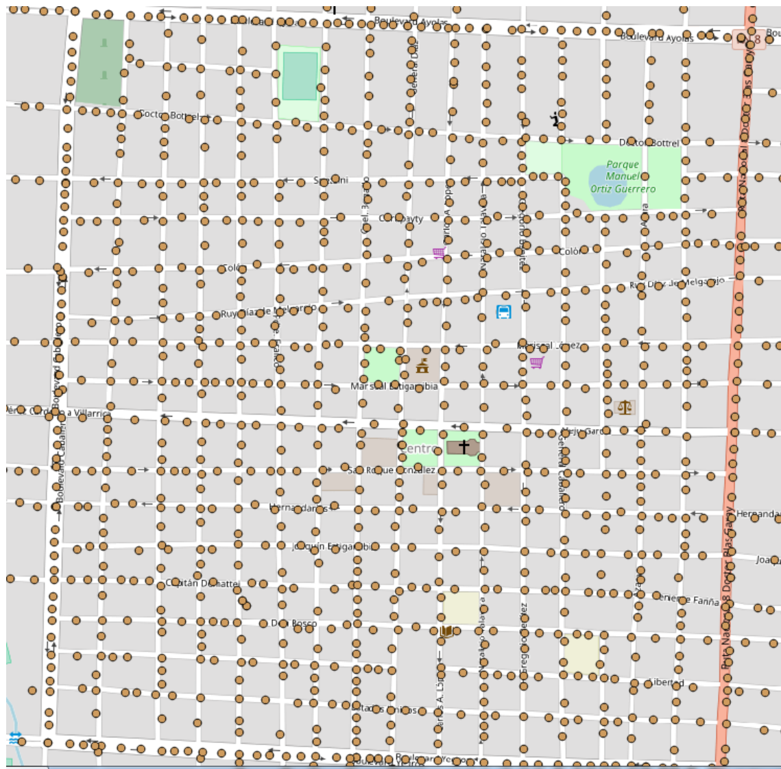
Figura B.2: Vista centrada en el microcentro de la ciudad del sistema de alumbrado público de la ciudad de Villarrica perteneciente a la concesionaria CLYFSA.
