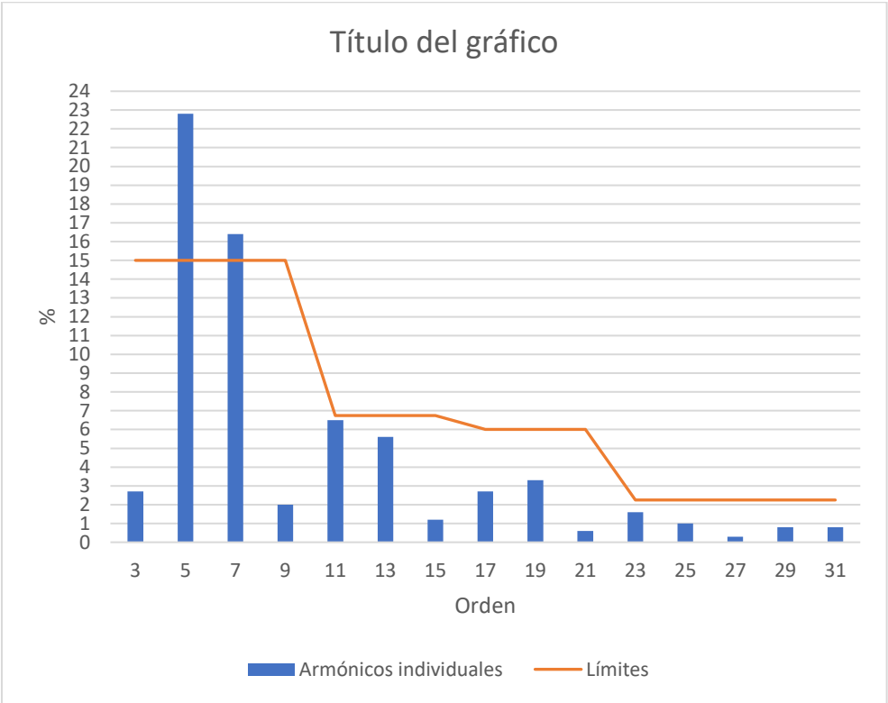
Figura 15. Percentil 99 de armónicos individuales impares de la corriente I_3 .
