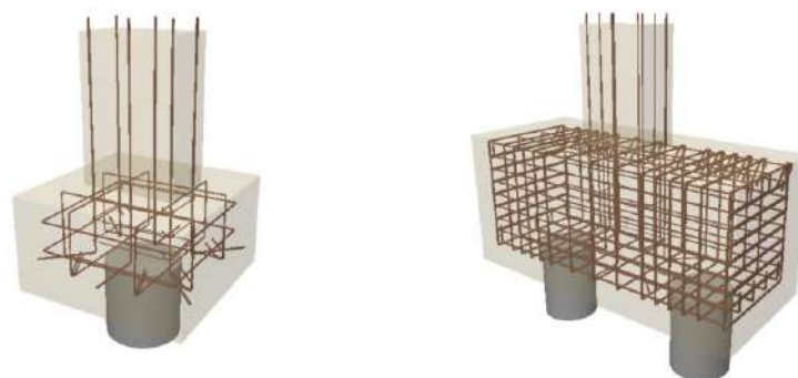
Figura 4. Agrupaciones de pilotes con cabezales
