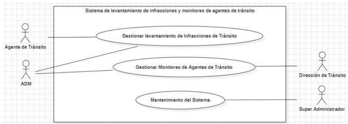
Ilustración 1 Diagrama de alto nivel del sistema para el levantamiento de infracciones de tránsito, monitoreo de los agentes de tránsito.
