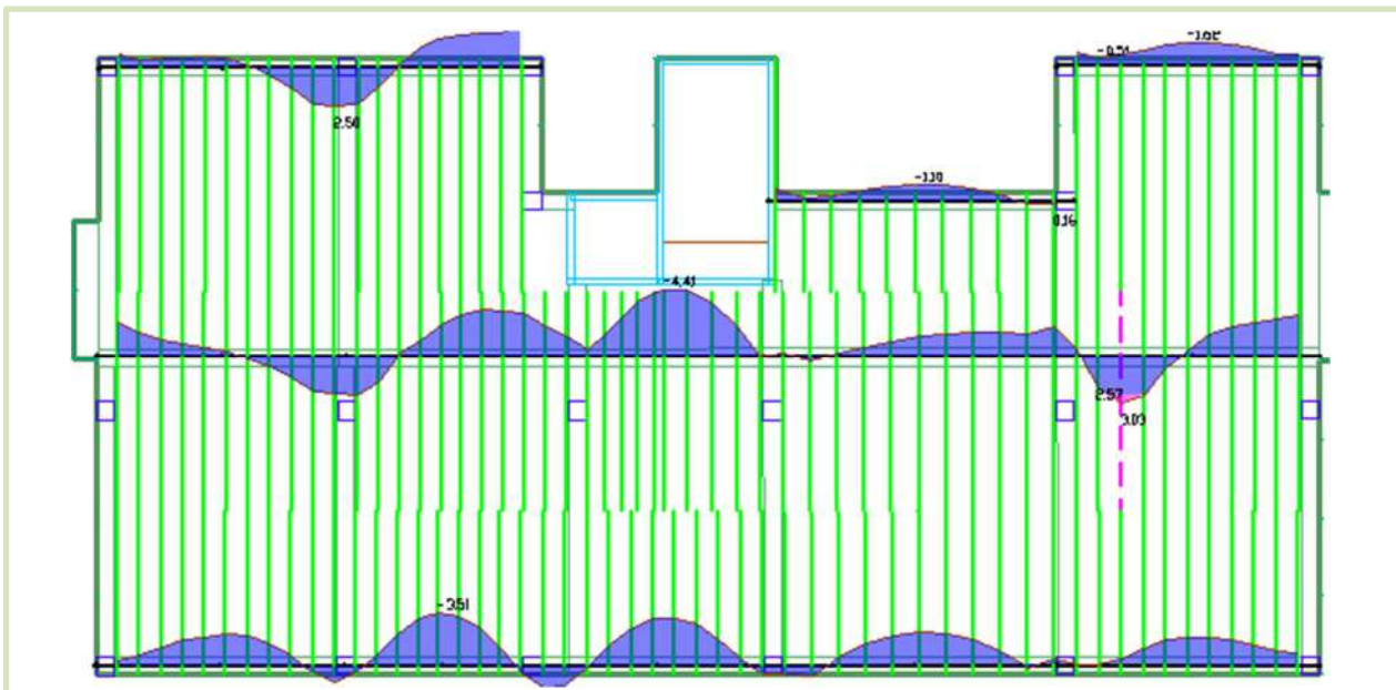
Figura 11.79 – Tensiones en la fibra inferior en estado de servicio en losa del Modelo N°8. Líneas de soporte horizontal. Fuente: Elaboración propia
