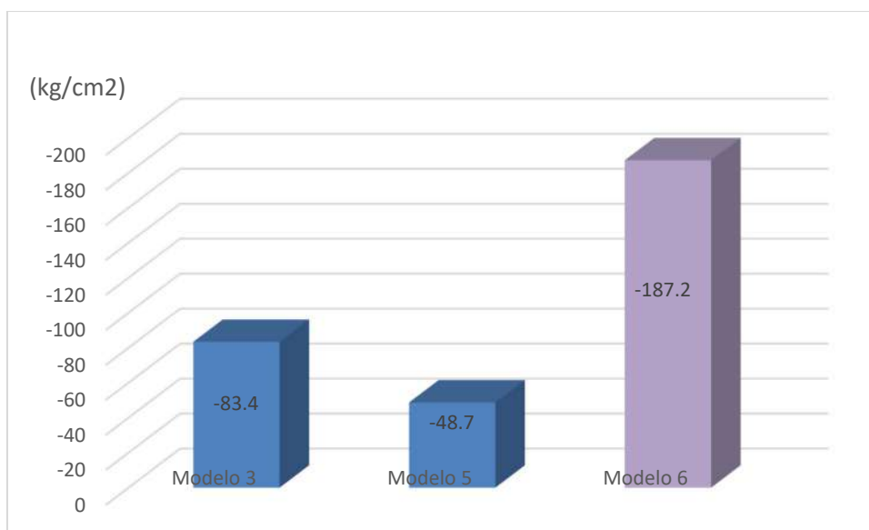
Figura 12.36 - Comparación de Influencia de la cantidad de cordones en la tensión de compresión en la fibra inferior, estado de servicio inicial. Fuente: Elaboración propia
