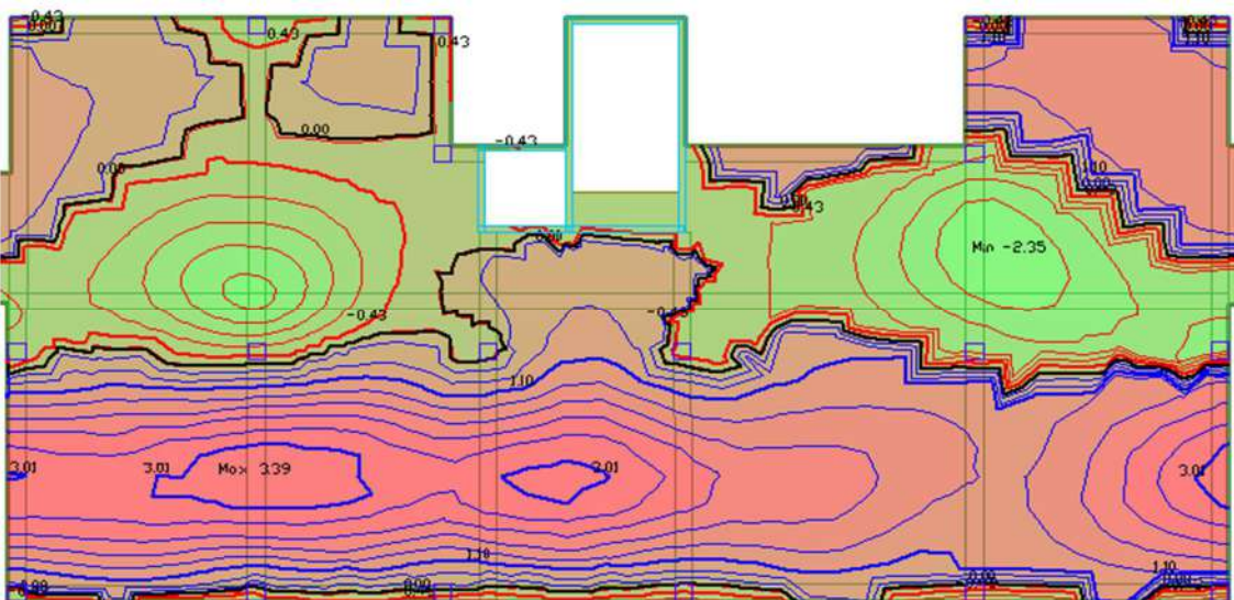
Figura 11.59 – Valores de deformaciones de la losa en el estado inicial de cargas en el Modelo N°6. Fuente: Elaboración propia
