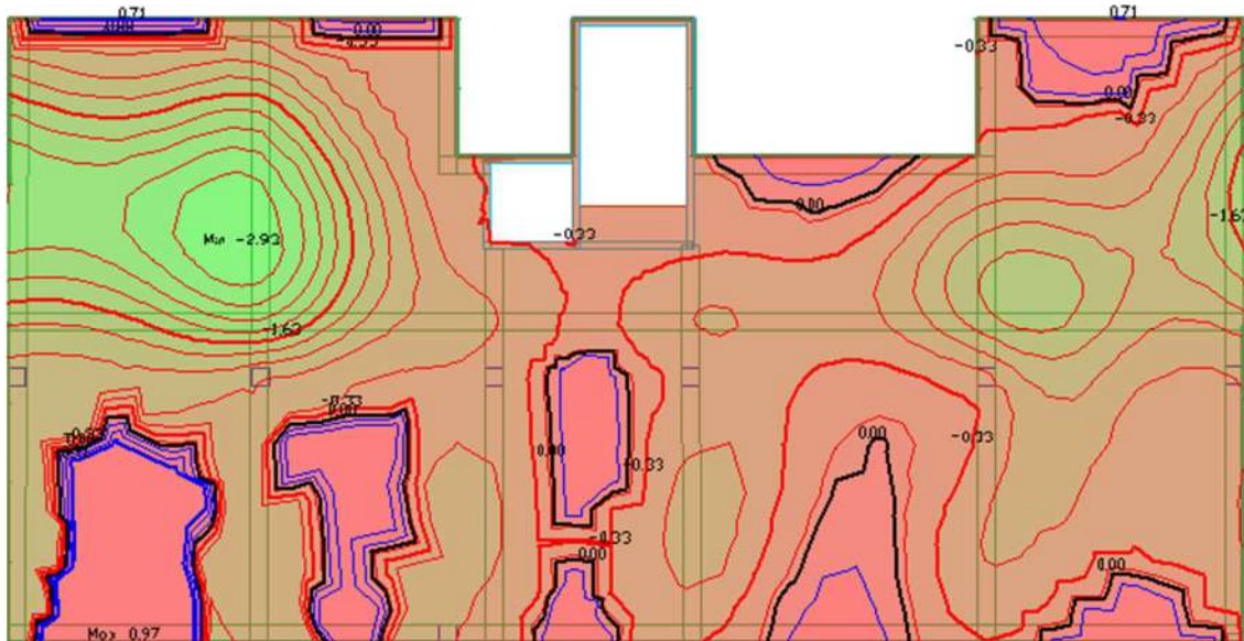
Figura 11.75 – Valores de deformaciones de la losa en el estado inicial de cargas en el Modelo N°8. Fuente: Elaboración propia
