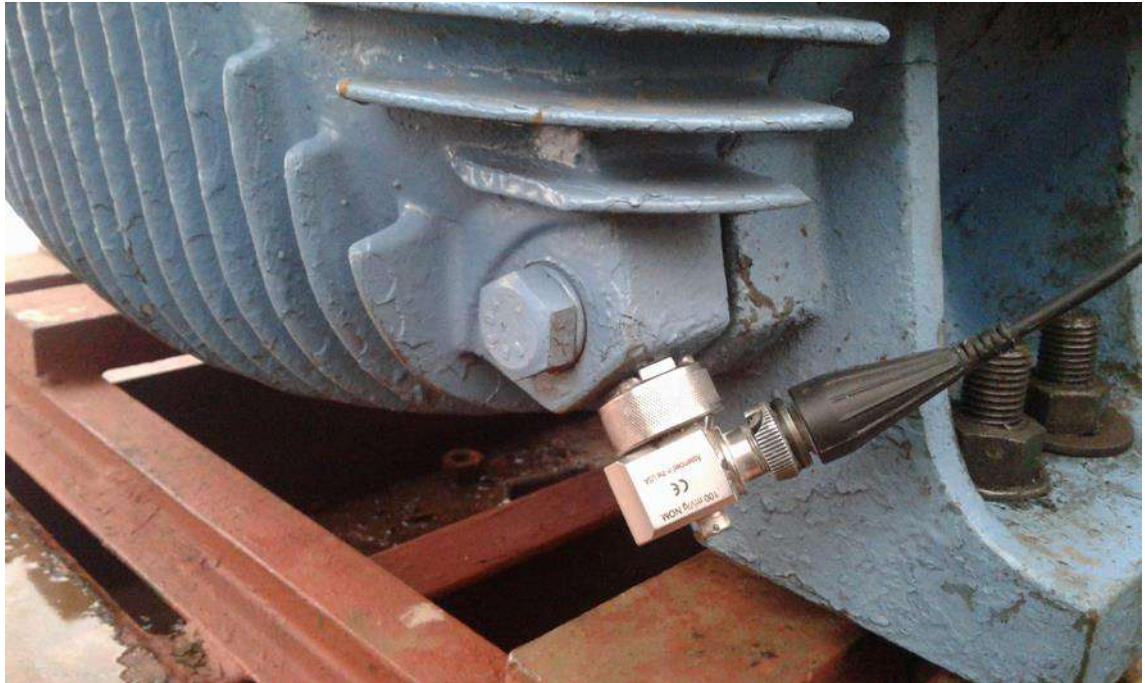
Figura B.5.2: Orientación del punto de prueba del acelerómetro.
