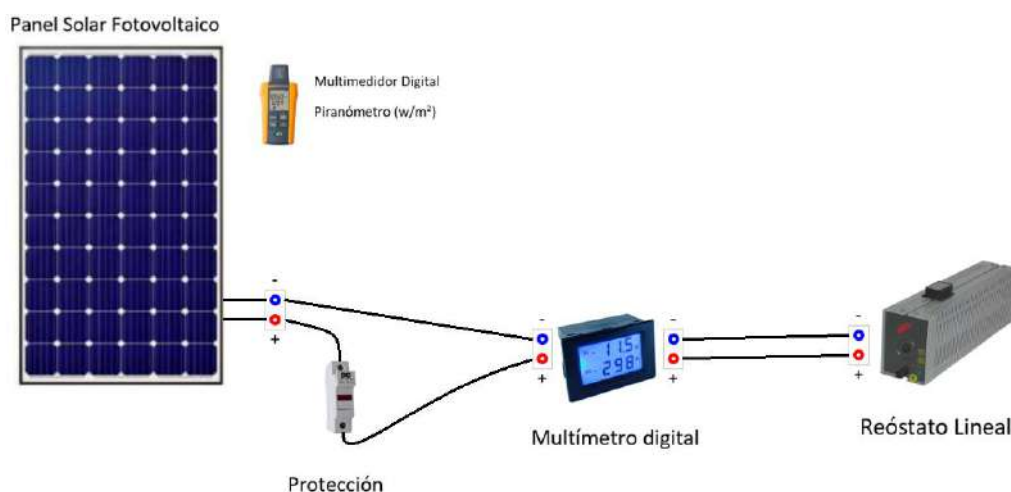
Figura 13. Esquema de Conexionado para la Curva Característica I-V.
