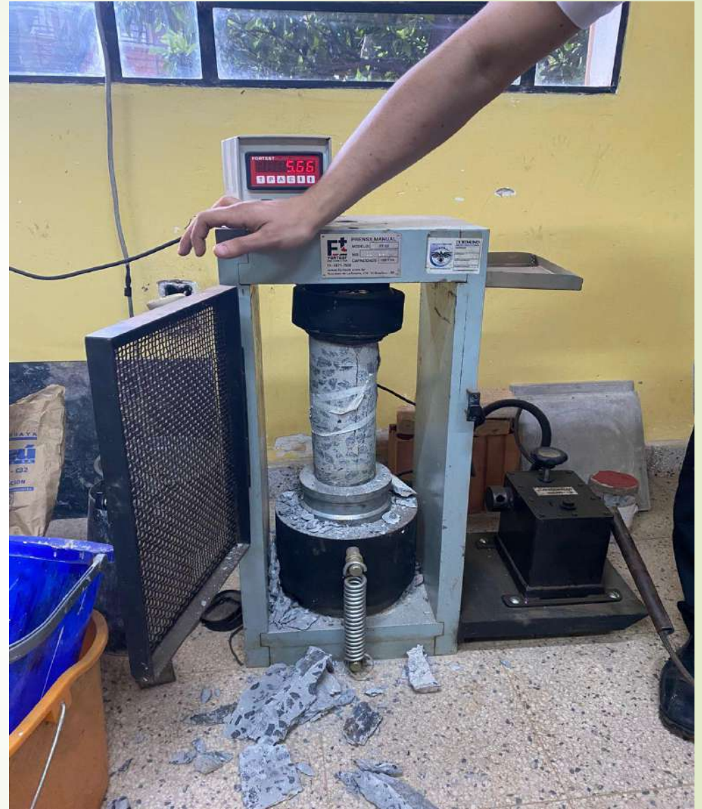
Proceso de rotura de las probetas testigo- Fuente: Elaboración propia.
