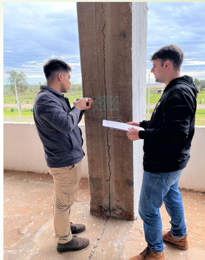
Realización del ensayo de dureza superficial – Fuente: Elaboración propia.
