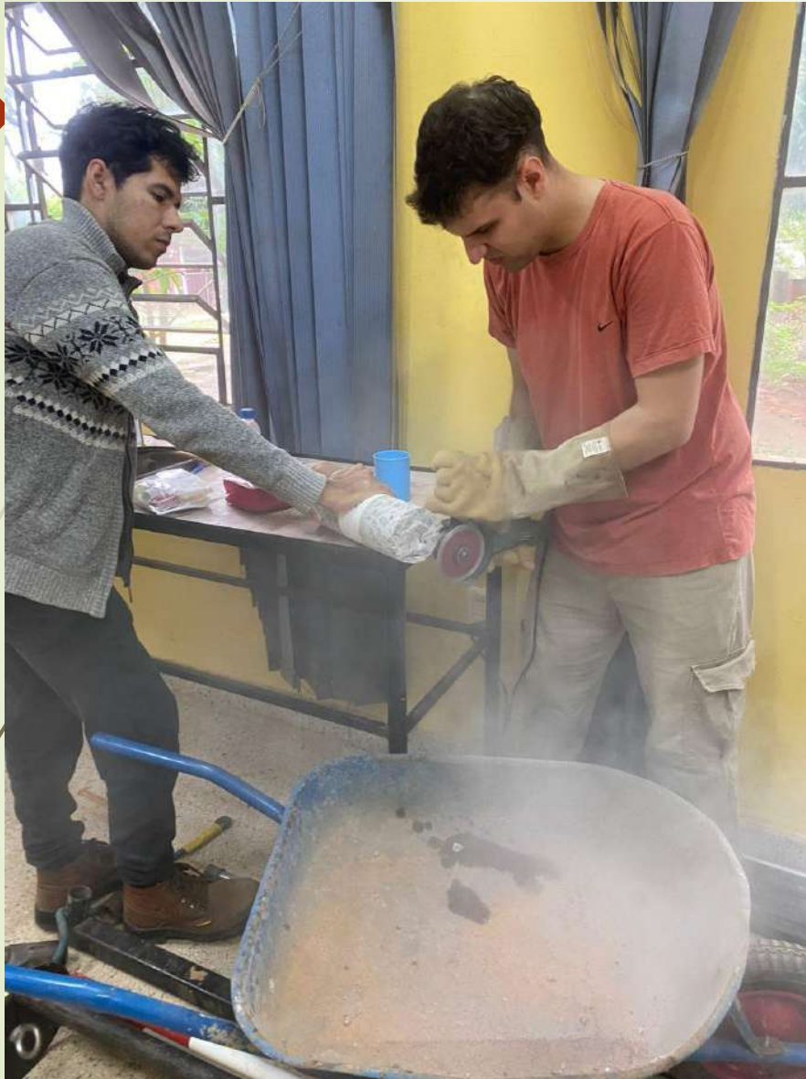
Proceso de rotura de las probetas testigo- Fuente: Elaboración propia.
