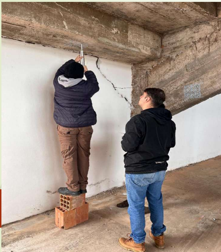
Realización del ensayo de dureza superficial – Fuente: Elaboración propia.
