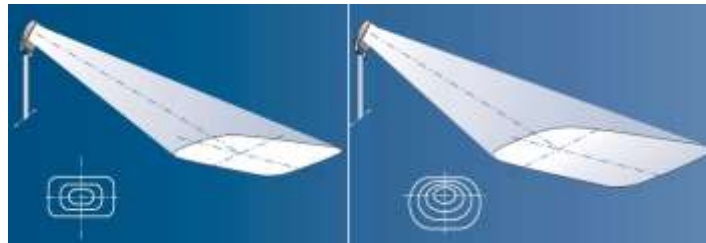
Figura 3.4. Haz de luz de proyectores rectangulares.
