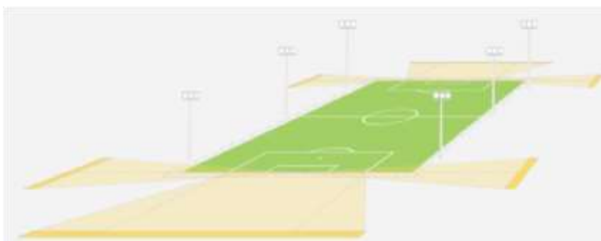
Figura 3.23. Planificación de la instalación (eventos no televisados) Clase II: Partidos de liga y/o clubes.
