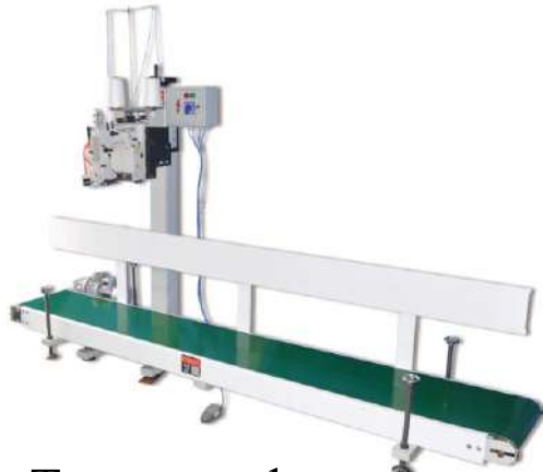
Cinta Transportadora con Maquina de Cosedor Fija
