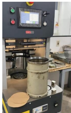
Figura 61 - Muestra lista para compactar
