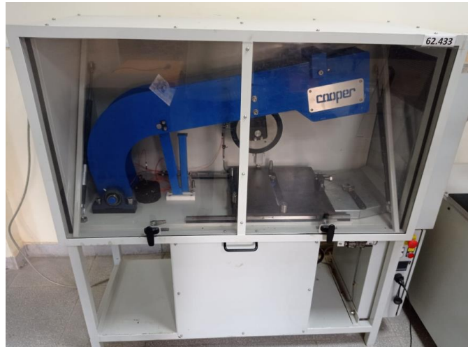
Figura 65 - Máquina de Wheel Tracking Test.
