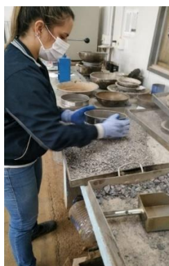
Figura 6 -Tamizado en laboratorio.
