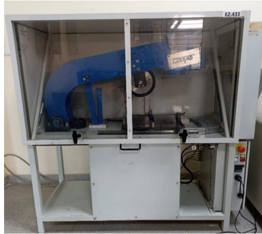
Figura 48 - Equipo de Wheel Tracking Test y detalles de la configuración para cada metodología.
