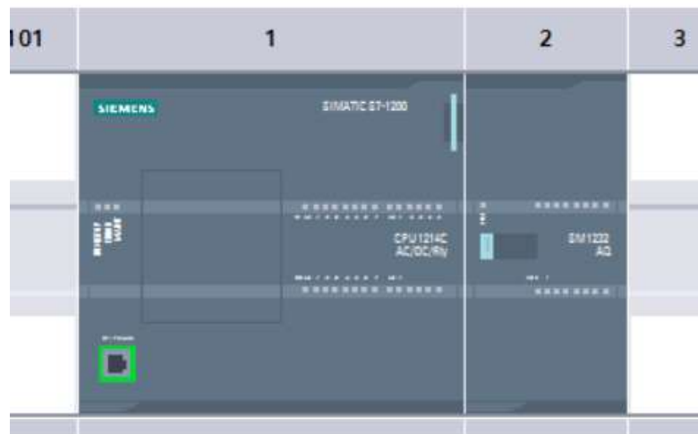
Figura 6.20 Rack de módulo PLC S7-1200 y módulo analógico de salida SM1232 AQ.
