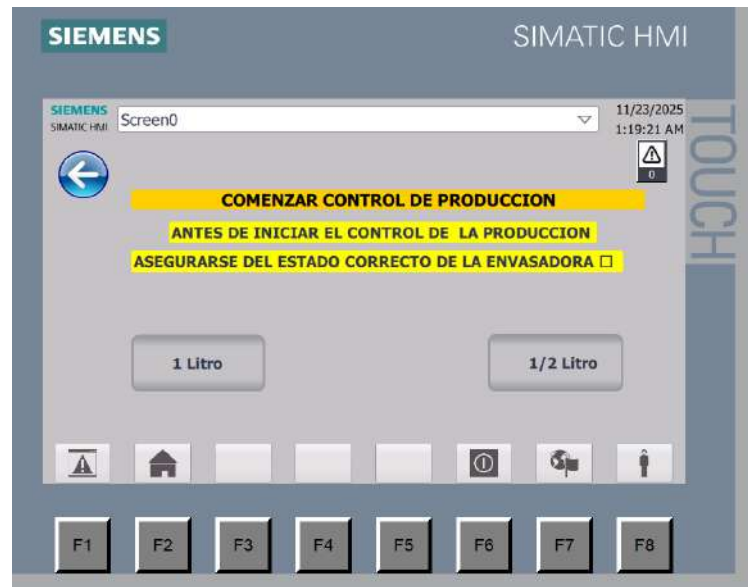
Figura 2.7 Panel de selección del modo de operación.
