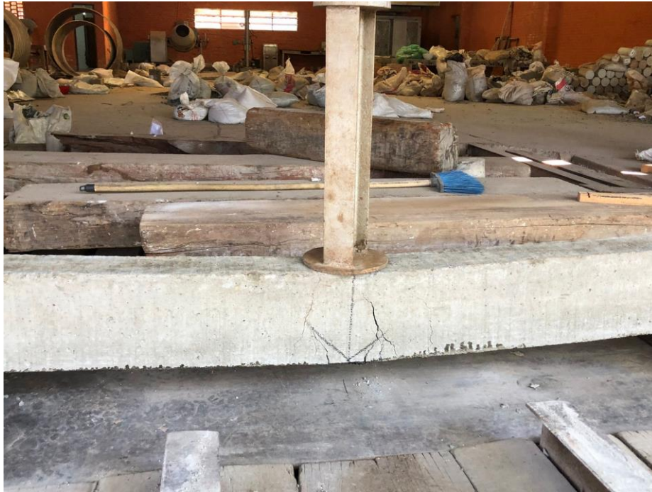
Las primeras fisuras por flexión
