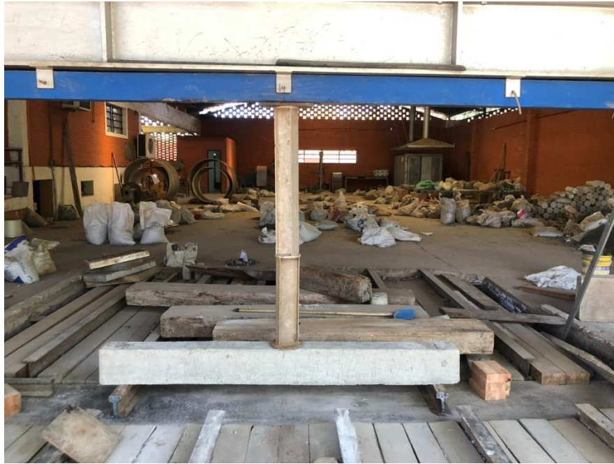
Preparación para rotura de probeta de viga de hormigón armado sin refuerzo
