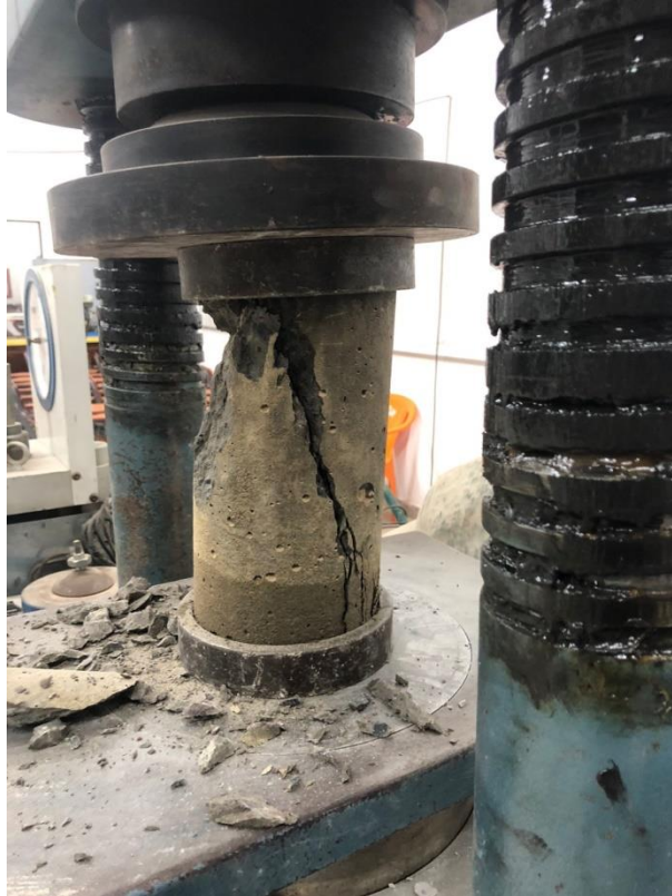
Rotura de Probeta cilíndrica
