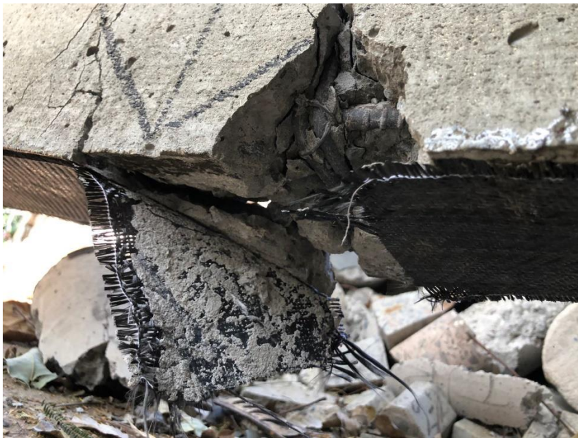
Las primeras fisuras por flexión
