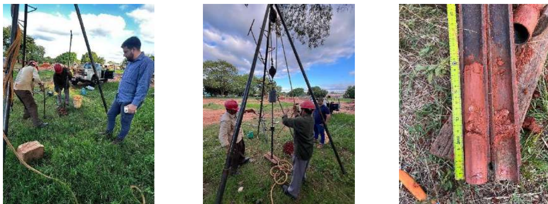
Figura 5. Estudio geotécnico – Ensayo de Penetración Estándar. (SPT)
