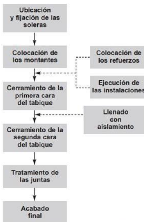
Figura 2. Esquema del proceso constructivos Steel Framing.
